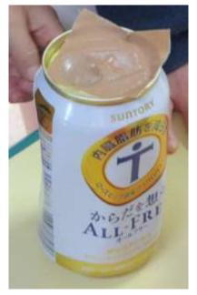
最初の実験に戻りますが、密閉していたガムテープが内側にへこみ始め、しば らくすると…缶が急に「ポコッ」とへこみました!
