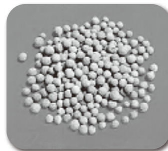
コンクリート固化物の例
