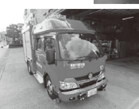
水を常時積載し、消火栓などの水利から水を取らなくてもすばやく放水活動に移行することができ、セイリ、少量の水で効率良く消火ができる圧縮空気泡消火装置(CAFS装置)を搭載しています。そのほか、さまざまな救助資機材を積載していますので救助活動にも活用します。
