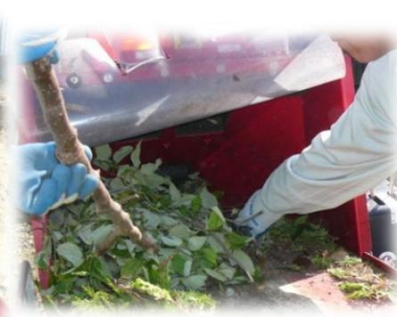
この機械の中で大きな「なた」のような刃が回転して粉碎しています
